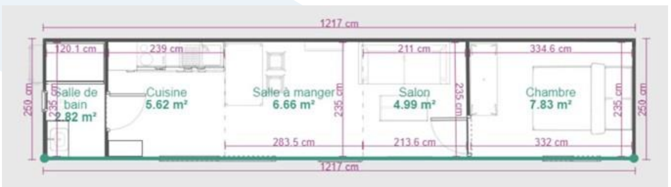
Studio avec salle de bain au bout du container avec une chambre cloisonnée
